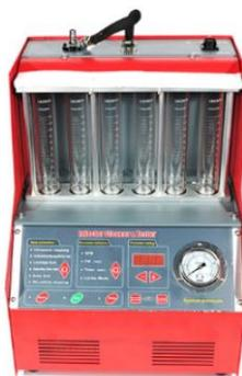
**CNC-602A** - самый популярный стенд для диагностики и ультразвуковой очистки бензиновых форсунок в России, позволяющий работать со всеми типами форсунок современных инжекторов.
