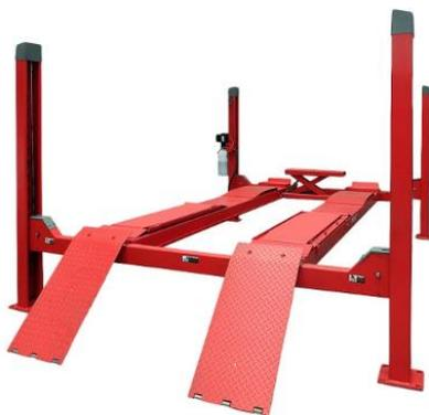
Подъемник имеет грузоподъемность 4 тонны и предустановленную траверсу 2,0 тонны с пневматическим управлением. Пневматическое управление стопорами осуществляется с помощью центрального пульта. Подъемник можно быстро адаптировать под слесарные работы за счет быстрого снятия платформ со сдвижными пластинами и платформ для заезда на поворотные круги. Подъемник соответствует международным требованиям и стандартам безопасности.
